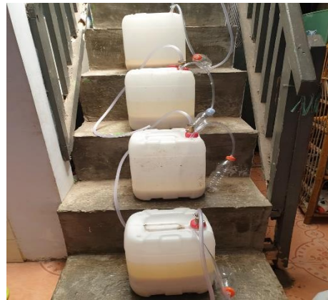
Gambar 6 Digester yang sudah berisi MOL
