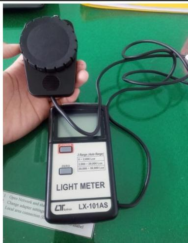
Gambar 5. Alat Light Meter (Untuk Pengukuran Pencahayaan)
