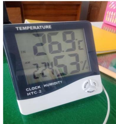
Gambar 4. Alat Thermometer Digital (Untuk Suhu dan Kelembaban)
