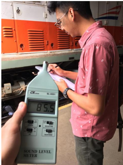
Pengukuran dan Pencatatan Kebisingan
