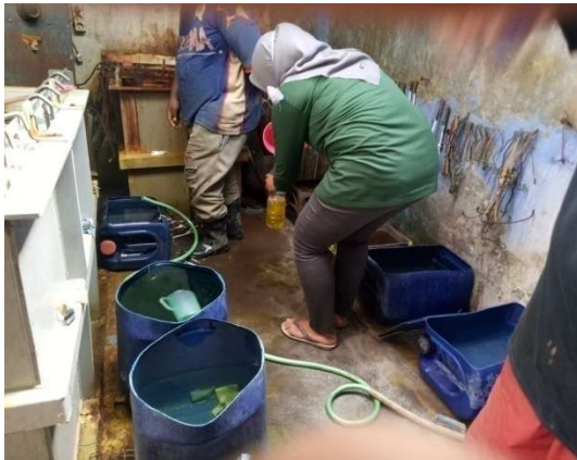
Gambar 3. Pengambilan sampel air limbah pelapisan logam krom
