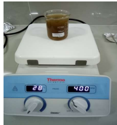
Gambar 8. Proses pengadukan sampel menggunakan magnetic stirrer
