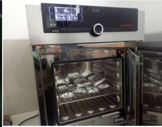
Gambar 2. Proses pengeringan kulit kacang tanah menggunakan oven
