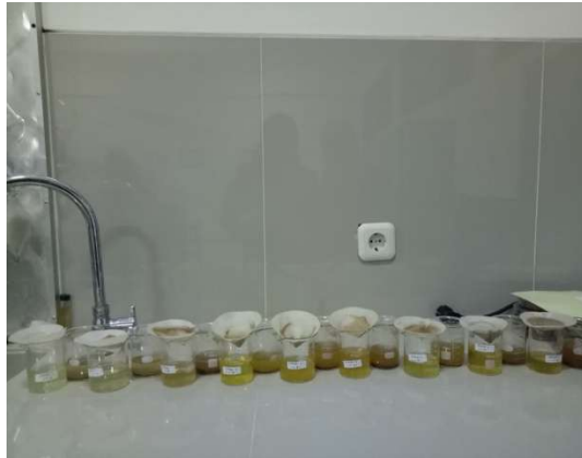
Gambar 9. Proses penyaringan bioadsorben kulit kacang tanah
